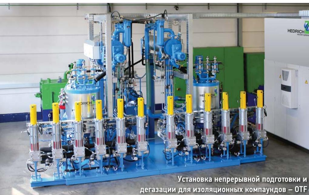
Установка непрерывной подготовки и дегазации для изоляционных компаундов – ОТФ
