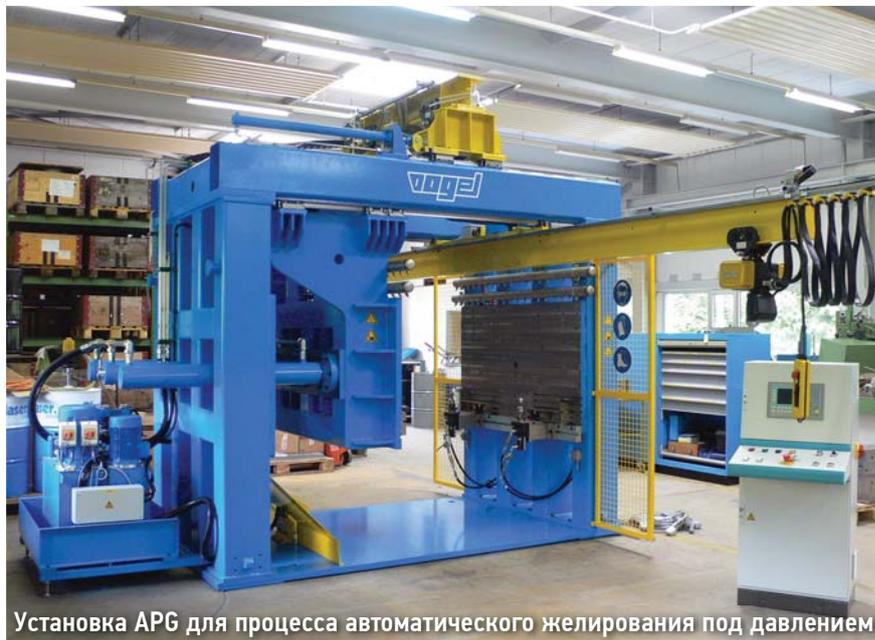
Установка APG для процесса автоматического желирования под давлением
