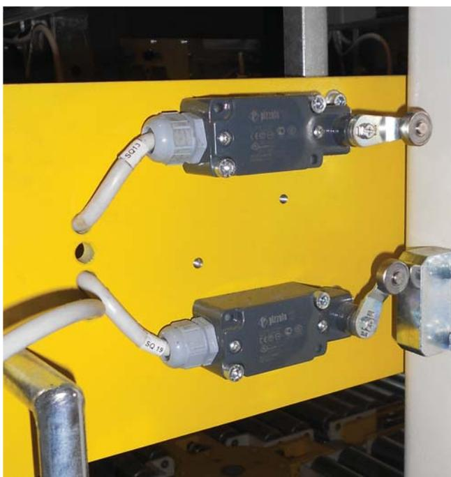
Пример работы концевых выключателей — нижний датчик активирован
